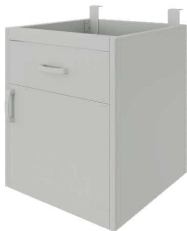
Навесная комбинированная тумба изготовлена из стали. Тумба имеет ящик с телескопическими направляющими полного выдвижения и одну дверку. Нижний отсек комплектуется металлической регулируемой полкой. Фасад ящика и дверка заполнены шумопоглощающим материалом. Тумба может быть установлена на каркас лабораторного стола. Все стальные элементы изделия окрашены порошковой краской.
